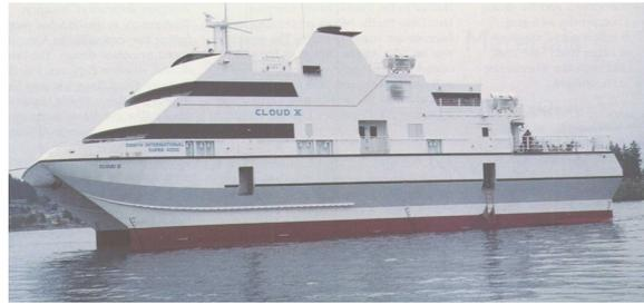
**Figura 23 – Embarcação do tipo SWATH**
